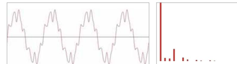
Darstellung der Oberschwingungen einer verzerrten Sinusspannung
