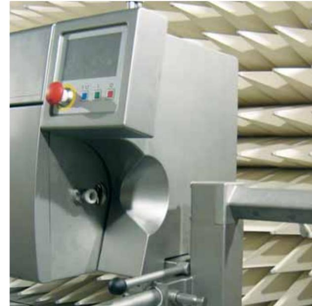
Für die Messung der Störfeldstärke werden speziell abgestimmte Antennen benötigt. Die Feldstärkemessung kann im Freifeld oder in unserer gegen äußere Störeinflüsse abgeschirmten Absorberkabine erfolgen. Hier muss zwischen H-Feldern und E-Feldern unterschieden werden. Das H-Feld (magnetische Feld) wird im Frequenzbereich von 9 kHz bis 30 MHz und das E-Feld (elektrische Feld) von 30 MHz bis 1 GHz (oder höher) messtechnisch erfasst.
