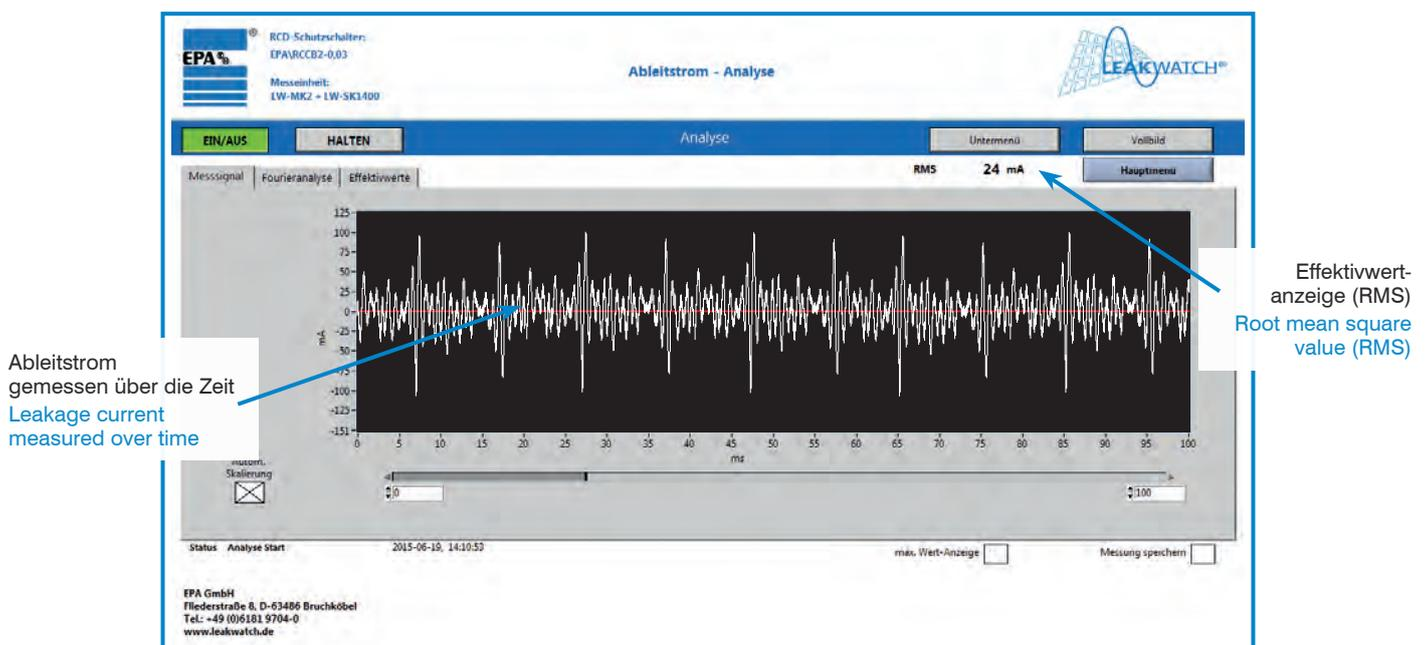
Die Darstellung des zeitlichen Verlaufs (Oszilloskop-Funktion) und des RMS-Wertes von 20Hz bis 300kHz.
