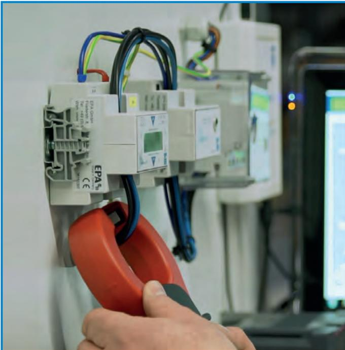
Messzange LW-MZ-50 im Einsatz: Messen ohne Trennen des Strompfades, auch bei größeren Kabelquerschnitten möglich
